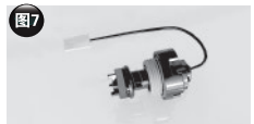
使止回阀与感应器连接, 检查是否通电, 如果不通电, 则感应器里的干簧管损坏
